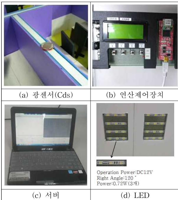
그림 4. 스마트 조명제어 관리시스템의 주요구성 요소 Fig. 4. Key components for smart lighting control management system
